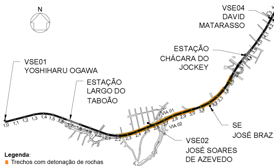
Figura 9 – Croqui esquemático dos trechos de escavação com detonação de rochas
