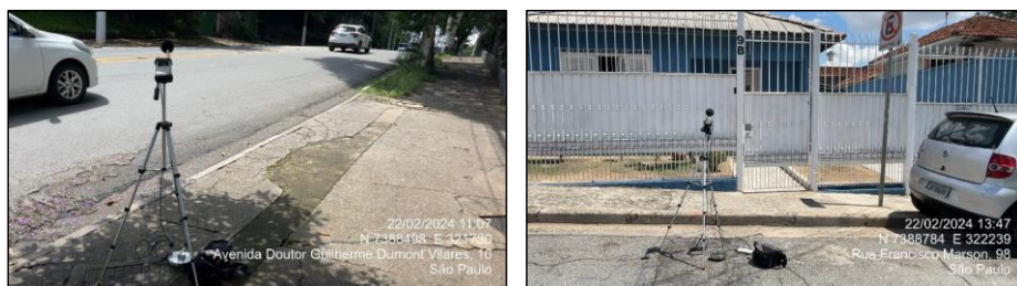
Foto 1 – Mosaico de exemplos de montagem dos equipamentos de medição de ruídos e vibrações
