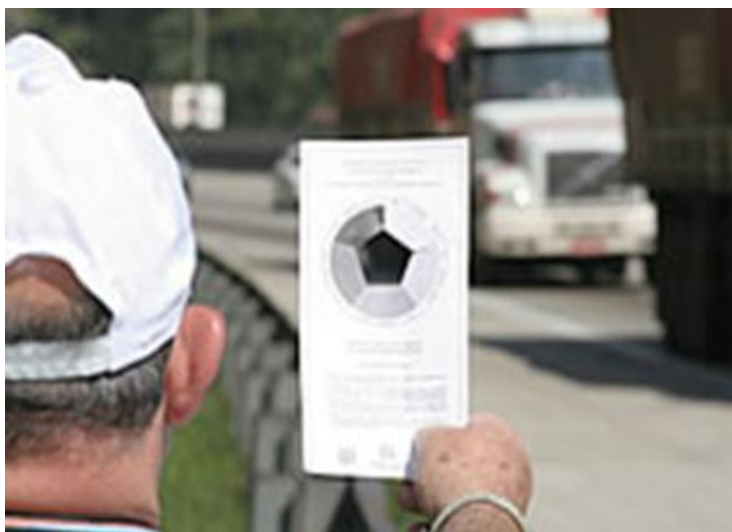
Figura 4 – Utilização da escala de Ringelmann reduzida
