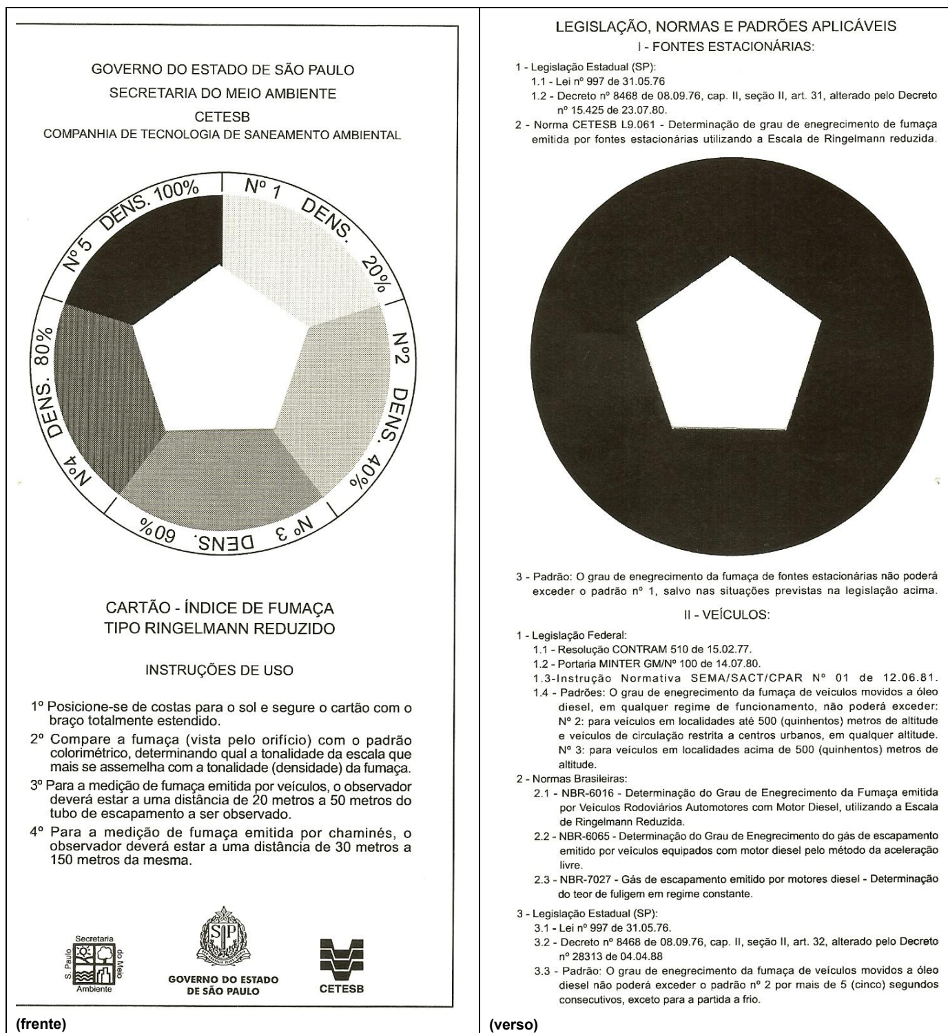
Figura 3 – Escala de Ringelmann reduzida
