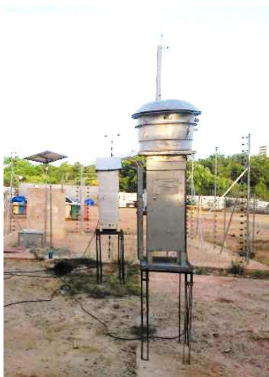
Figura 1 – Equipamento de monitoramento da qualidade do ar – amostradores de grande volume (AGV/ Hi-Vol)
